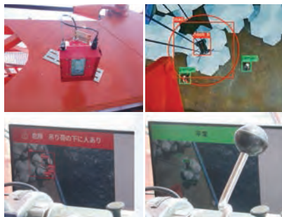
AIカメラを使用し据付位置を確認しながらピンポイントに据付
