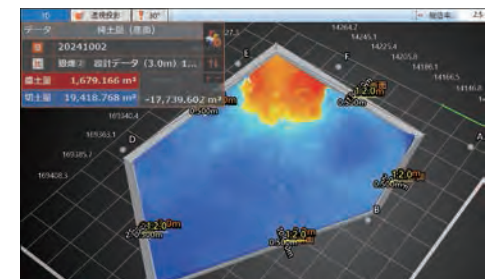
3次元測量データによる浚渫土量の把握
