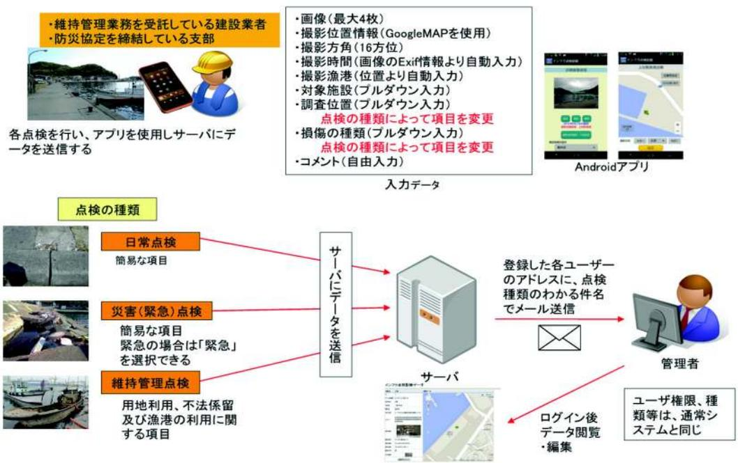
図-13 漁港施設点検システムの概要図
